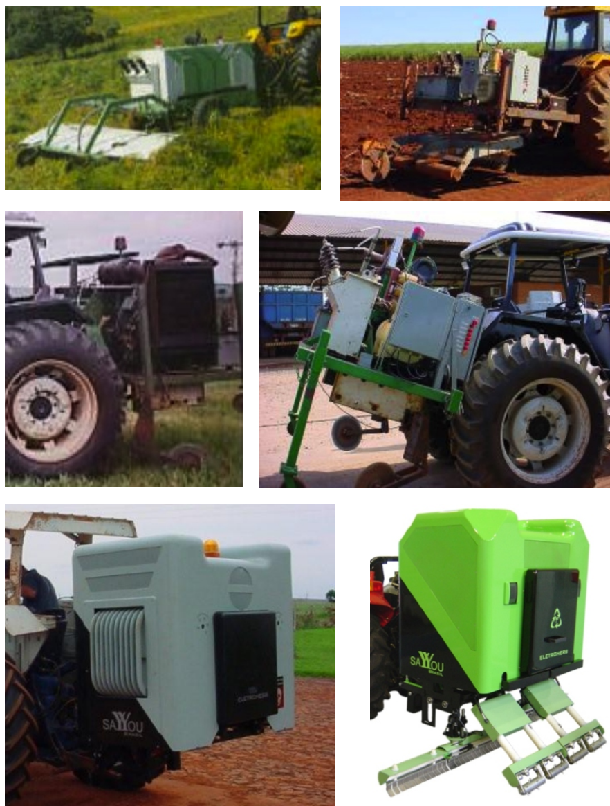
Figura 3. Imagens ilustrativas da evolução tecnológica dos equipamentos de eletrocussão em 1993 até 2012.
