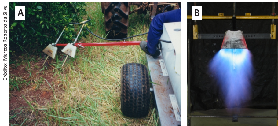
Figura 4. (A) Primeiro equipamento de arrasto importado para uso no Brasil utilizando queimadores do tipo “sino”. (B) Detalhes do funcionamento do queimador do tipo “sino”.
