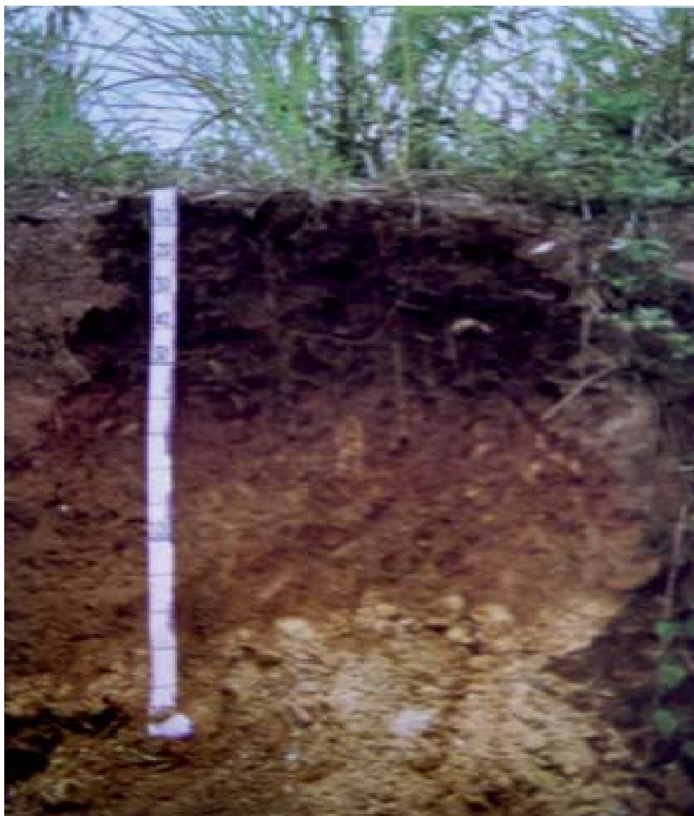
Figura 9a: Perfil de BRUNIZÉM AVERMELHADO textura média argilosa – Relevo ondulado Estrada São João do Paraíso – Mortugaba – BA. Fonte: Projeto RADAMBRASIL – Vol. 29
