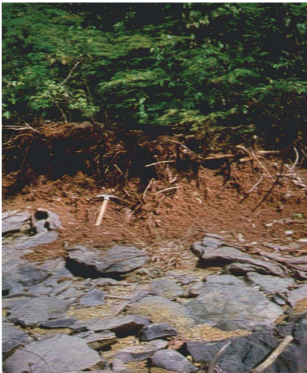
Figura 14a: Perfil de CAMBISSOLO EUTRÓFICO argila de atividade alta A moderado textura argilosa relevo ondulado Substrato Calcário. Estrada Santa Maria da Vitória – Caracol – BA. Folha SD.23-X-C. Fonte: Projeto RADAMBRASIL Vol. 29
