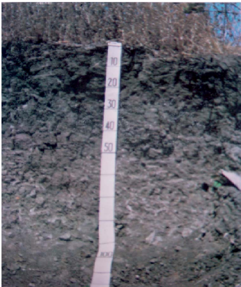
Figura 15b: Perfil de VERTISSOLO A chernozêmico relevo suave ondulado. Estrada Nova Olinda – Santana do Cariri 11 km de Nova Olinda – CE Fonte: Projeto RADAMBRASIL – Vol. 23
