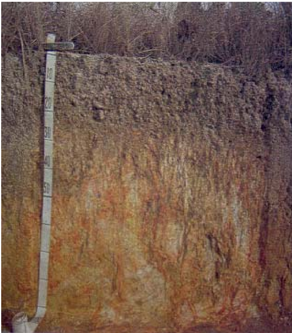
Figura 16: Perfil de LATERITA HIDROMÓRFICA ÁLICA argila de atividade baixa epiconcrecionária com B incipiente A moderado textura média relevo suave ondulado. Estrada Arraias- Cana Brava – TO. FONTE : Projeto RADAMBRASIL Vol 29
